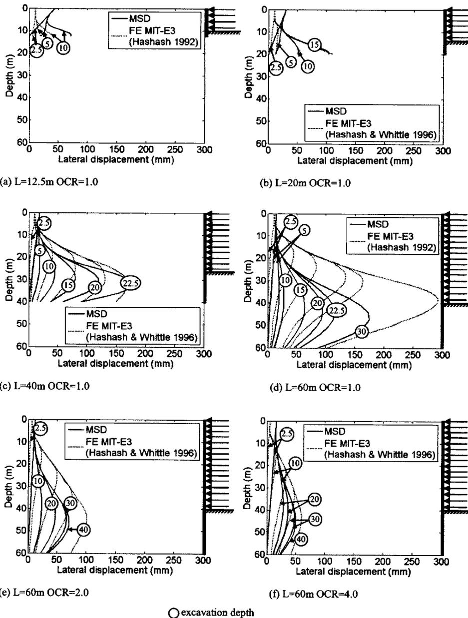
**Fig. 11.** Comparison between MSD and FE for lateral displacement profiles: (a)  $L=12.5$ ,  $OCR=1.0$ ; (b)  $L=20$  m,  $OCR=1.0$ ; (c)  $L=40$  m,  $OCR=1.0$ ; (d)  $L=60$  m,  $OCR=1.0$ ; (e)  $L=60$  m,  $OCR=2.0$ ; and (f)  $L=60$  m  $OCR=4.0$
