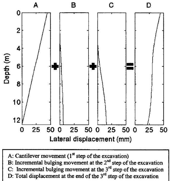
Fig. 21. Calculation example ( $L=12.5$  m,  $H=5$  m,  $h_u=2.5$ ,  $h=2.5$  m, and  $OCR=1.0$ )
